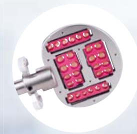
III. 3 L'usinage FAO des dents prothétiques est réalisé de façon similaire à la construction basale et circulaire.
