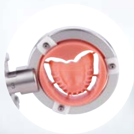
III. 4 Base en PMMA usinée définitive après l'essayage en bouche réussi du montage.
