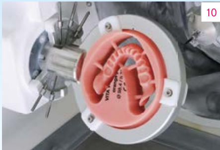
III. 10 La base de prothèse a été fabriquée avec un disque en PMMA VITA VIONIC BASE.
