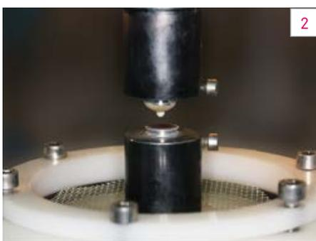
**Fig. 2** O teste de desgaste do pin-on-block (POB) foi realizado com uma bola de esteatite em oito amostras diferentes por marca.
