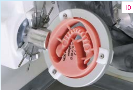
Bild 10 Protesbasen gjordes av PMMA-skivan VITA VIONIC BASE.
