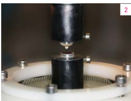
Bild 2 Pin-on-Block (POB) slitagetest genomfördes per fabrikat på åtta olika prover med en steatitkula.
