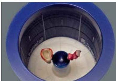
Los anillos de sectores en la parte interior del anillo de la mufla permiten una localización rápida y selectiva del objeto de prensado durante el proceso de retirada del revestimiento.
