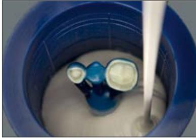
Verter el material de revestimiento con un chorro fino en el anillo de la mufla hasta llegar a la marca. Evitar la formación de burbujas.
