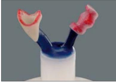
Las zonas de transición entre jito de prensado, objeto de prensado y base de la mufla deben estar redondeadas. Es muy importante evitar cualquier borde afilado y estrechamientos. Los jitos no deben estrecharse en dirección al modelado, sino que deben acabar en forma de trompeta.
