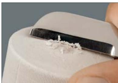
La plantilla de la mufla determina la altura del molde de material de revestimiento y facilita la posición vertical en el horno de prensado. Eliminar cualquier defecto en la base con la ayuda de un cuchillo para escayola para evitar una posición inclinada de la mufla en el horno de prensado y los problemas consiguientes en el proceso de prensado.
