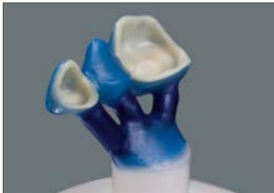
Las zonas de transición entre jito de prensado, objeto de prensado y base de la mufla deben estar redondeadas. Es muy importante evitar cualquier borde afilado y estrechamientos.
