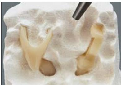
Aplicar un chorro de perlas de vidrio de 50 µm a una presión de 4 bar. Tras descubrir el objeto de prensado, reducir la presión del chorro a 2 bar.
