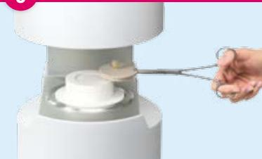
Prelevare il supporto di cottura col restauro e posizionarlo sul piano di raffreddamento.
