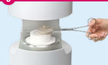
Posizionare il supporto di cottura con il restauro sullo zoccolo di cottura.
