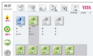
Fig. 2 Visualizzazione iniziale con collegamento di 2 forni VITA New Generation
