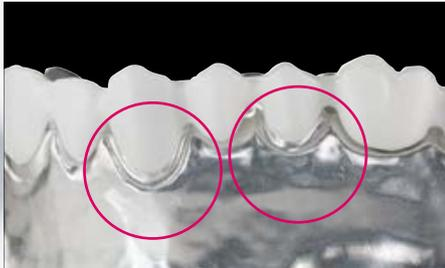
Fig. 1a Control visual del ajuste de VITA YZ T tras el proceso de sinterización utilizando un modelo de ajuste.
