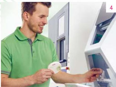
Fig. 4 Se carga con una pieza en bruto VITA YZ® ST el cargador de una unidad CAM.
