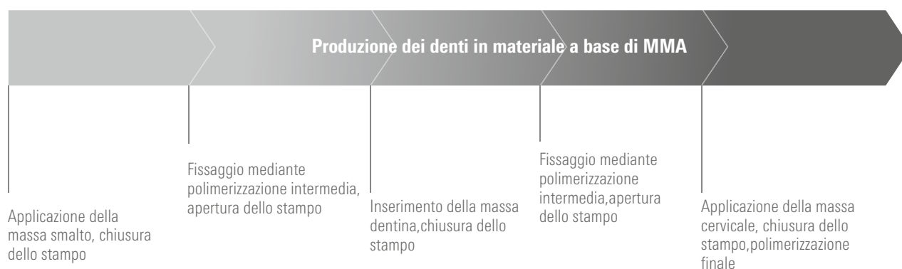
Figura 11: Rappresentazione schematica del procedimento di produzione di denti protesici in (P)MMA; fonte VITA R&S
