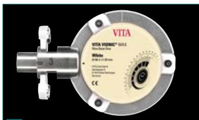
**1** Fissare il disco in cera White nel sistema di supporto.
