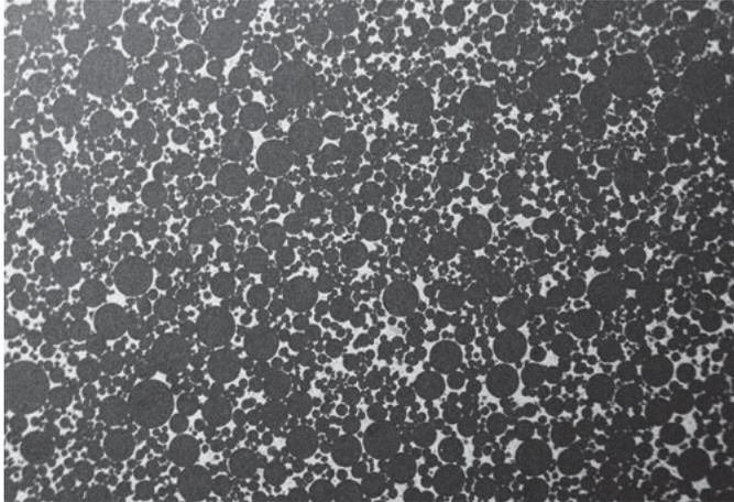
**Abb. 7** REM-Bild der Microfiller Reinforced Polymermatrix (MRP) im Querschnitt.
