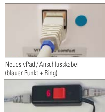
1/6 = Einschalter / Ausschalter nur für das vPad, Ofen wird über Hauptschalter ein-/ausgeschaltet
