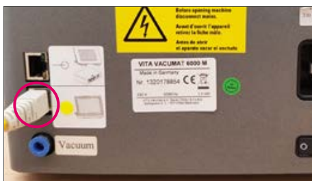
Unteren Anschluss verwenden (Brenngerät ab 05/2017)
