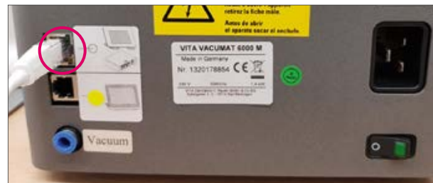
Oberer Anschluss verwenden (Brenngerät ab 05/2017)
