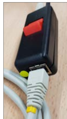
Injektor / Anschlusskabel (gelber Punkt + Ring)
