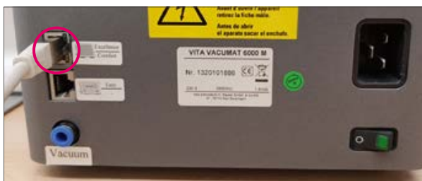
Oberer Anschluss verwenden (Brenngerät bis 04/2017)
