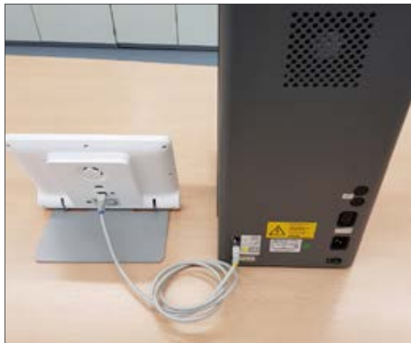
Das vPad wird direkt am Brenngerät angeschlossen
