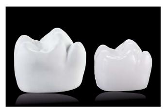
**Figura 6:** Esempio della retrazione di sinterizzazione del biossido di zirconio pari a ca. 20 %
