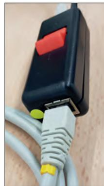
Injecteur/câble de raccordement
