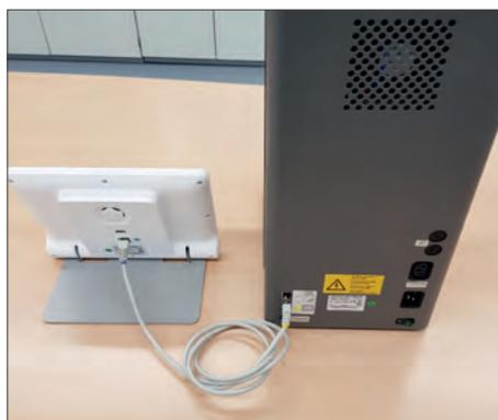
Le vPad est raccordé directement à l'appareil de cuisson.
