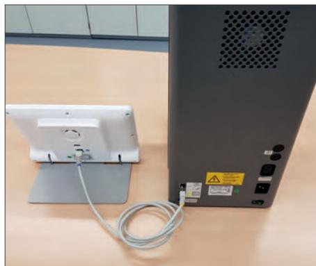
Das vPad wird direkt am Brenngerät angeschlossen
