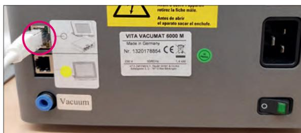
Utiliser le raccord du haut (appareil de cuisson à partir du 05/2017)
