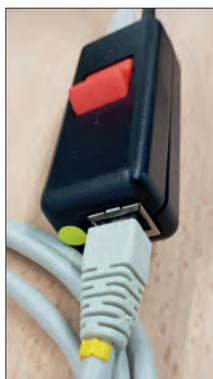
Inyector/cable de conexión
