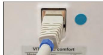
Nuevo vPad/cable de conexión
