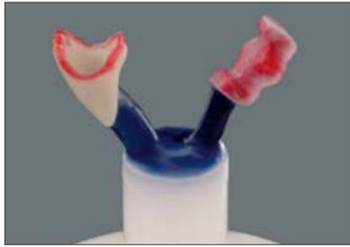
Ansatzstellen zwischen Presskanal, Pressobjekt und Muffelbasis müssen abgerundet sein. Scharfe Kanten und Verengungen sind unbedingt zu vermeiden. Die Anstiftung darf sich zur Modellation hin nicht verjüngen, sondern sollte „trompetenförmig“ auslaufen.
