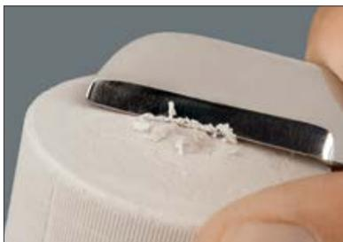
Die Muffellehre bestimmt die Höhe der Einbettmassenform sowie den geraden Stand im Pressofen. Störstelle an der Standfläche mit einem Gipsmesser begradigen bzw. sorgfältig entfernen, da sonst die Muffel nicht senkrecht im Pressofen steht und es zu Problemen beim Pressen kommen kann.
