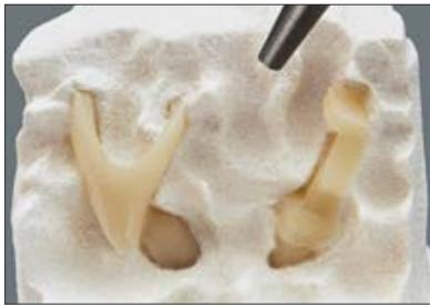
Grobes Abstrahlen mit Glasperlen mit 4 bar und 50µm Körnung. Bei sichtbarwerden des Pressobjektes Strahldruck auf 2 bar vermindern.
