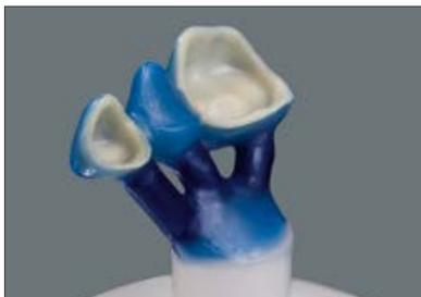
Les zones de jonction entre la tige, l'objet et la base du cylindre doivent être arrondies. Il faut impérativement éviter les bords à angles vifs et les rétrécissements.
