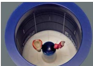
A l'aide des anneaux sectoriels dans l'intrados du cylindre, le repérage de l'objet est rapide et précis au démoulage.
