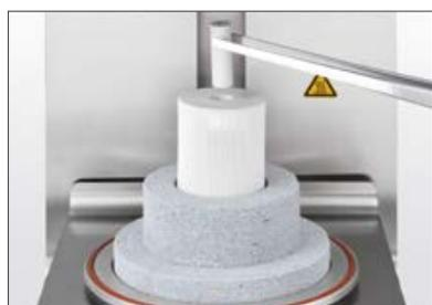
Mise en place du piston à usage unique avec le repère noir dirigé vers le haut. La face avant légèrement arrondie au niveau des bords doit être orientée vers le bas.
