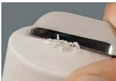
Le gabarit de cylindre détermine la hauteur du moule en revêtement ainsi que la position droite dans le four de pressée. Aplanir soigneusement la base avec un couteau à plâtre sinon le cylindre ne sera pas à la verticale dans le four et cela provoquera des problèmes lors de la pressée.
