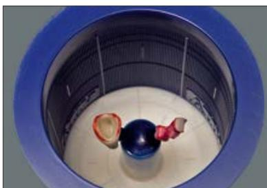
Com base nos anéis do setor no interior do anel de mufla, é possível uma recuperação rápida e direcionada do objeto de injeção durante a desinclusão
