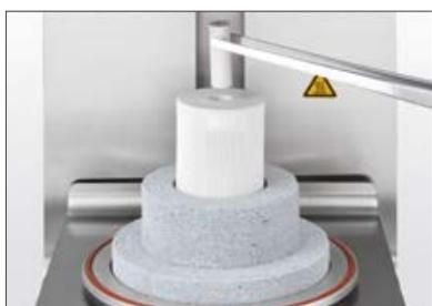
Colocação do êmbolo descartável com a marcação em preto para cima. A extremidade ligeiramente arredondada nas bordas deve apontar para baixo.
