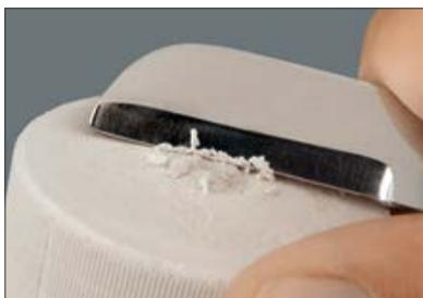
O medidor de mufla determina a altura da forma do material de revestimento, bem como o nível no forno de prensagem. Endireite o defeito na base com uma faca de gesso ou remova-o com cuidado.
