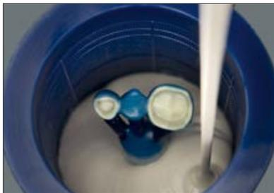
Despeje o material de revestimento no anel de mufla sem bolhas e em um fio fino até a marcação.
