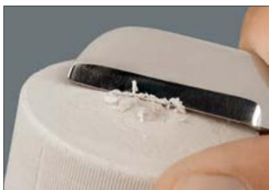
Лера муфеля определяет высоту застывшей паковочной массы, а также прямое положение в пресс-печи. Выступы на опорной поверхности разравнивать ножом для гипса или аккуратно удалить, иначе муфель будет стоять в печи неровно, что может привести к проблемам при прессовании.
