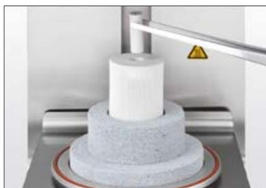
Установка одноразового плунжера для прессования черной меткой вверх. Слегка закругленные по краям торцевые поверхности должны быть обращены вниз.
