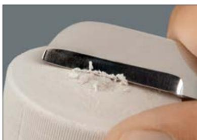
Лера муфеля определяет высоту застывшей паковочной массы, а также прямое положение в пресс-печи. Выступы на опорной поверхности разровнять ножом для гипса или аккуратно удалить.
