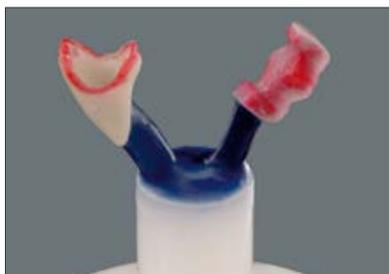
Места стыков между литьевым каналом, прессуемым изделием и цоколем муфеля должны быть скруглены. Ни в коем случае не допускать острых кромок и сужений. Литникообразующие штифты не должны суживаться к модели, но завершаться воронкообразным расширением.
