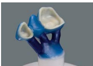
Места стыков между литьевым каналом, прессуемым изделием и цоколем муфеля должны быть скруглены. Ни в коем случае не допускать острых кромок и сужений.
