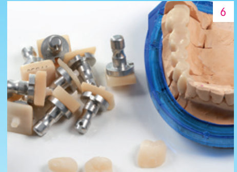
Abb. 6 Innerhalb einer Stunde wurden die Verblendstrukturen mit der inLab MC XL-Einheit geschliffen.
