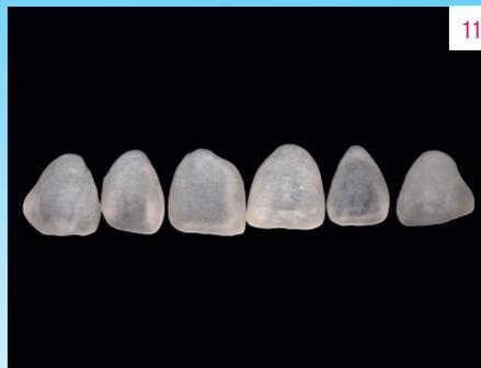
Fig. 11 Gracias a la finura de su grano, la cerámica de silicato de litio reforzada con dióxido de circonio VITA SUPRINITY PC posibilita un fresado muy preciso.
