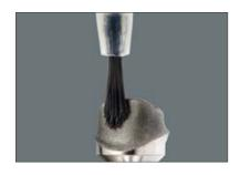
Após a limpeza, a superfície a ser colada não deverá ser mais tocada para que não haja contaminação, o que poderia afetar adversamente a união adesiva subsequente.
