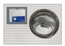
Limpar a base de titânio com banho de água ultrassônico, com álcool ou através de um jato de vapor e secar com ar livre de óleo.
