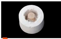
Realizar la retirada basta del revestimiento con Al<sub>2</sub>O<sub>3</sub> (granulación de 50 µm) a una presión de 4 bar.
