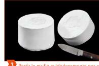
Partir la mufla cuidadosamente por el punto de rotura utilizando un cuchillo.
