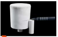
Utilizar un segundo émbolo de prensado, marcando la profundidad de prensado.
