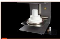
Colocar la mufla caliente sobre el disco de prensado universal.
