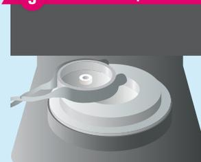
Retirer l'anneau de contrôle de la température et mesurer avec le pied à coulisse.
