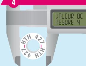
Tourner l'anneau de contrôle de la température de 45° supplémentaires et mesurer entre le chiffre et la lettre.
