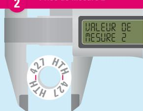
Tourner l'anneau de contrôle de la température de 45° et mesurer entre le chiffre et la lettre.
