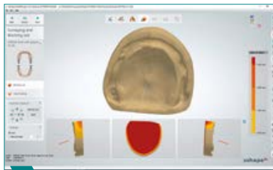
5 Definir la dirección de inserción. Deben tenerse en cuenta las socavaduras.
