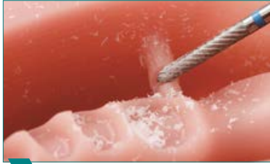
4 Separar del disco las bases de prótesis.
