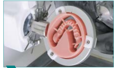
3 Fresar la base de prótesis inferior definitiva.
