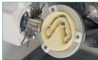
3 Фрезерование воскового диска для полноформатного воскового примерочного образца.
